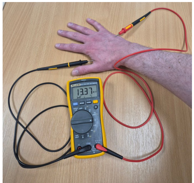
Bild 2: Menschenhand mit einem Widerstand von 1,3 \times 10^7 \Omega im Erkennungsbereich für Typ C FIBC-Objekte.
