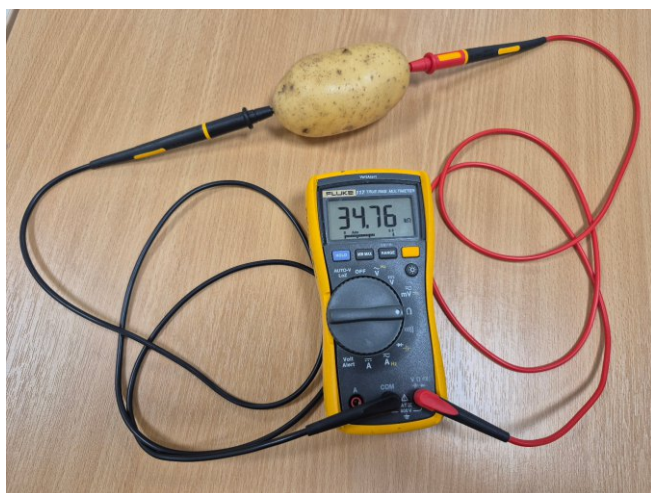
Bild 3: Kartoffel mit einem Widerstand von 3,5 \times 10^4 \Omega , innerhalb des Erkennungsbereichs für Typ C FIBC-Objekte.
