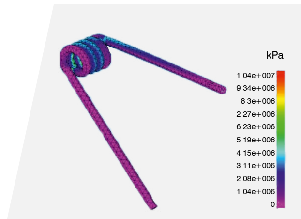
Le molle di Newson Gale sono progettate e analizzate con l'ausilio della tecnologia dell'analisi degli elementi finiti.
