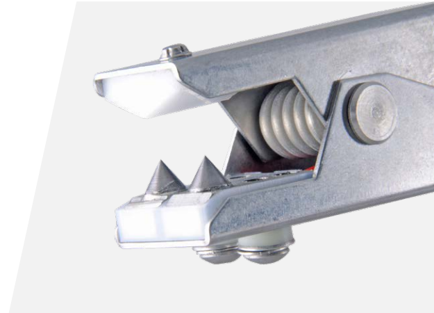
Le punte in carburo di tungsteno sono progettate per superare le impedenze elettriche causate da ruggine, rivestimenti e depositi di prodotto.
