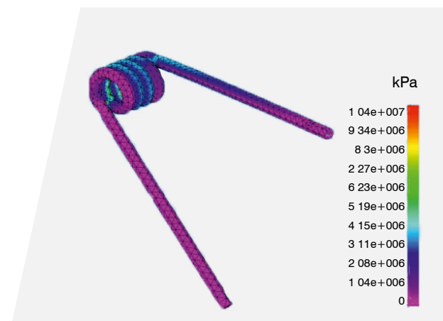
Federn von Newson Gale werden mit der Finite-Element-Methode entwickelt und analysiert.
