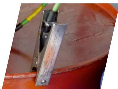
Le pinze di messa a terra statica devono essere in grado di penetrare attraverso rivestimenti, depositi di prodotto e ruggine per assicurare un buon collegamento elettrico alle attrezature di processo. Gli operatori dovrebbero essere addestrati a spostare la pinza in avanti e all'indietro in modo che penetri attraverso il rivestimento, fino a vedere il metallo sottostante.
