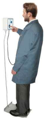
Testen von ableitfähigen Schuhen vor dem Betreten von Gefahrenbereichen
