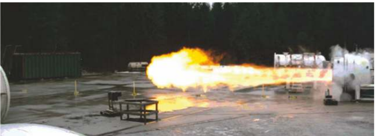
Abb. 3 - Eine aus der Druckentlastungseinrichtung eines geschlossenen Behälters austretende Staubexplosion (Abbildung mit freundlicher Genehmigung durch IEP Technologies)
